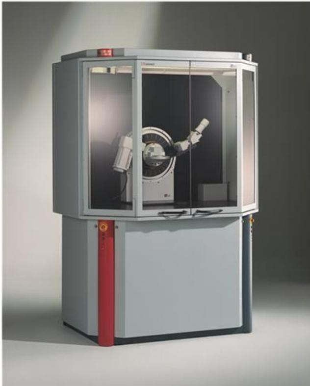
D8 ADVANCE, eine erstmals 1997 eingeführte neue Generation von Röntgenpulverdiffraktometern
