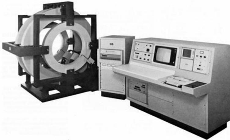
1983: Einer der ersten Ganzkörper-MRT-Tomographen mit Luftspulenmagnet
