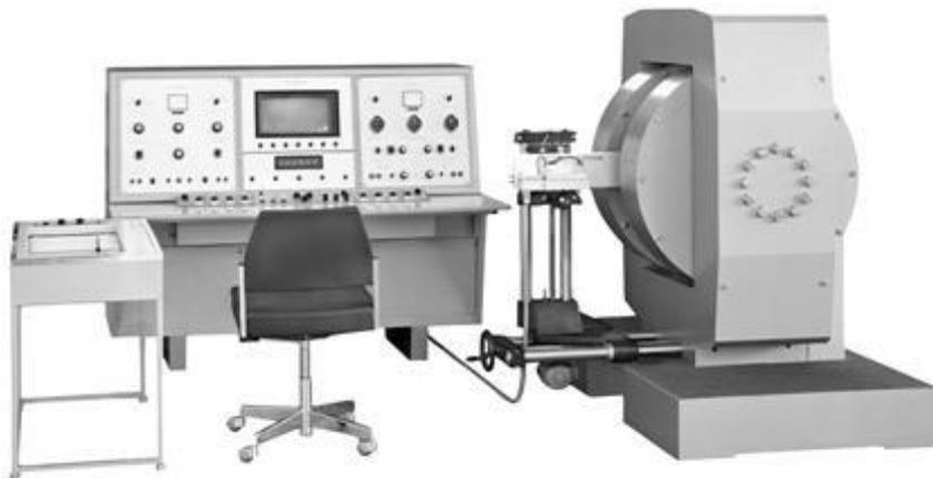
1967: HFX 90, das erste voll transistorisierte NMR-System mit drei Kanälen
