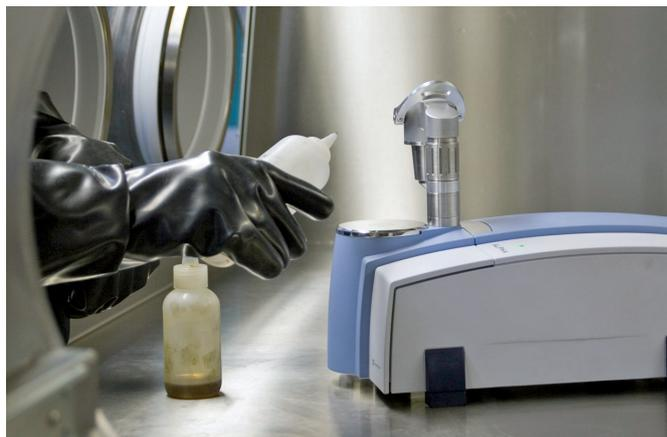
Abbildung 6: ALPHA Spektrometer innerhalb einer Glovebox.
