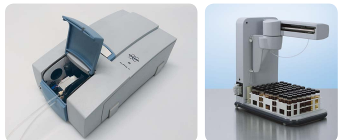
Abbildung 1: ALPHA II FT-IR-Spektrometer (links) für die Ölanalyse und Autosampler AIM3300 (rechts) mit Ölfラスchen bestückt.
