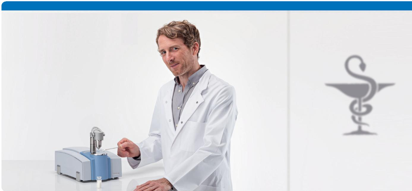
• **ALPHA II** Kompaktes FT-MIR-Spektrometer zur Identitätsprüfung gemäß Ph. Eur. Kapitel 2.2.24
