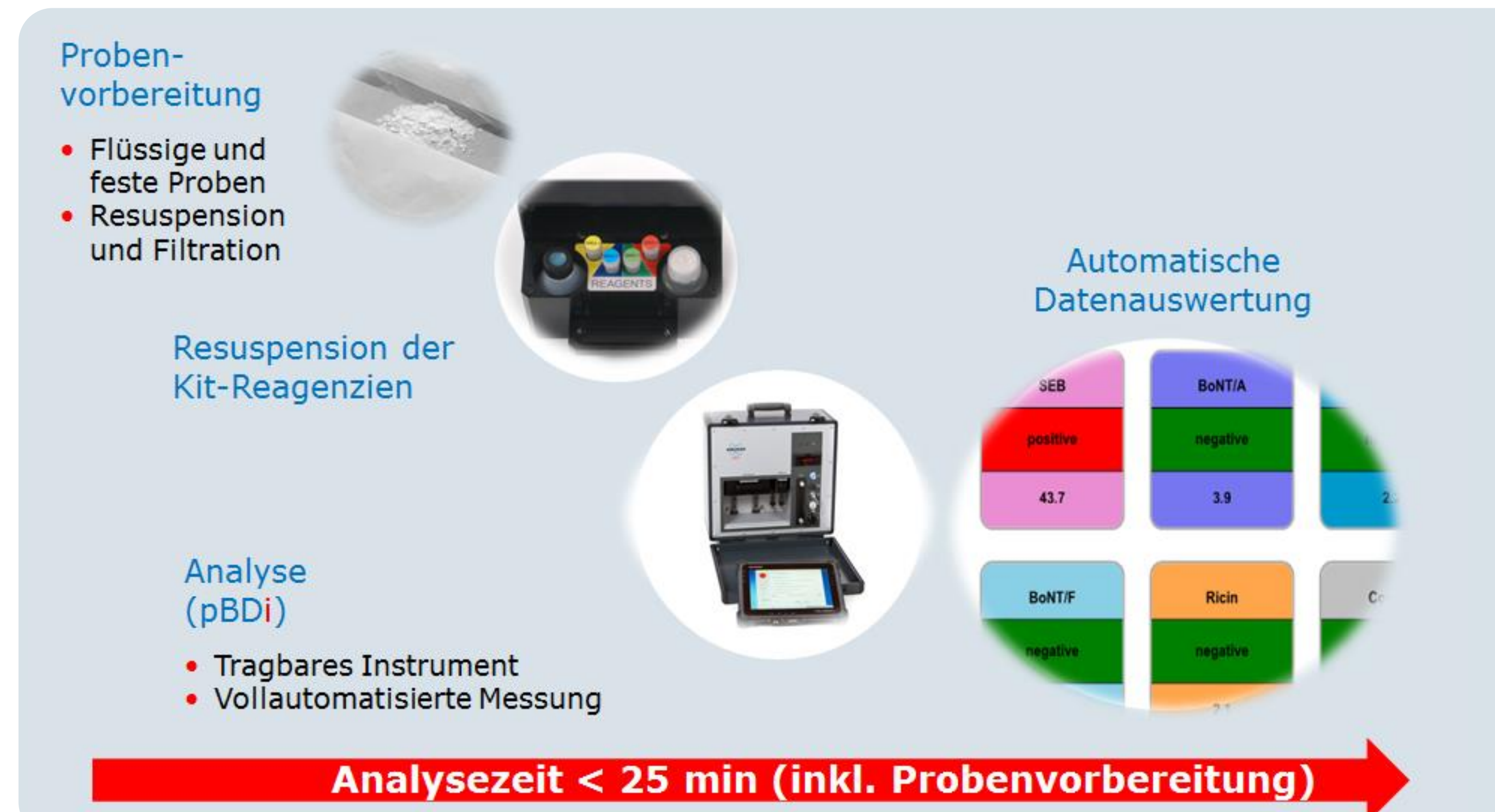
Abb. 2 Ablauf der automatischen Toxin-Detektion mittels der pBDi-Plattform.
