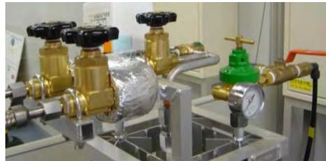
3. ELF管と気化器を金属製のホースで接続する
