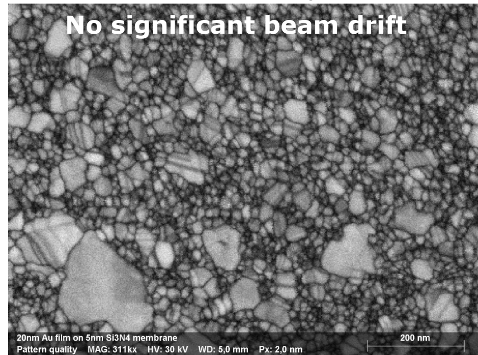
20nm Au film on 5nm Si 3 N 4 membrane
