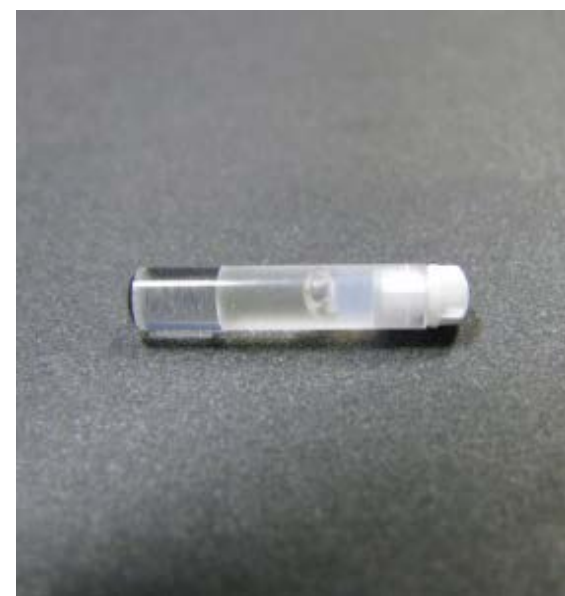
ローター底面にマーカを塗れば、実験準備完了です
