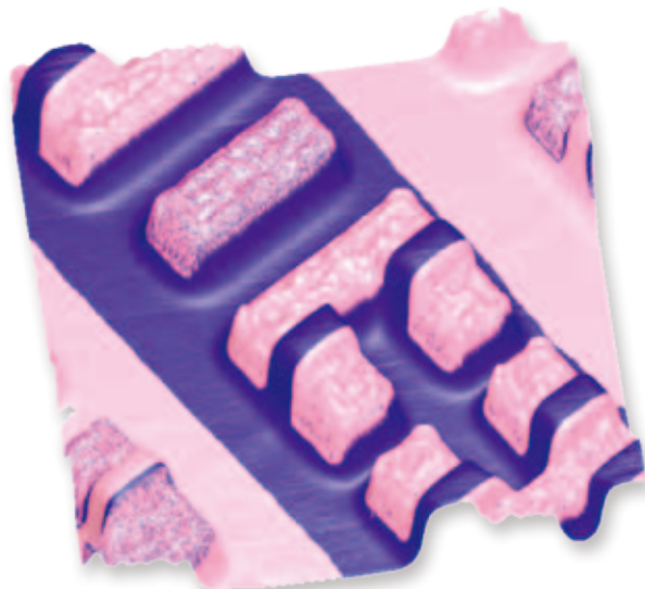
ダークリフト SCM を使用した SRAM サンプル上の高精度な 2 次元ドーパントプロファイリング。イメージサイズ 15 \mu m。
