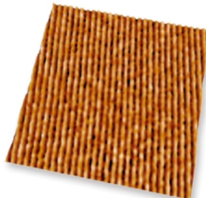
HOPG 上の C_{36}H_{74} アルカンのクローズドループ位相 イメージ。オールドランス構造の C_{36}H_{74} 鎖の長さに 一致する約 4.5nm 間隔のラメラ構造が明瞭に描出 されている。イメージサイズ 130nm。
