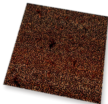
ポリ（スチレン-b-ブタジエン-b-スチレン）トリブロック共重合体中のマイクロ相分離を描出したクローズドループの位相イメージ。イメージサイズ 2μm。
