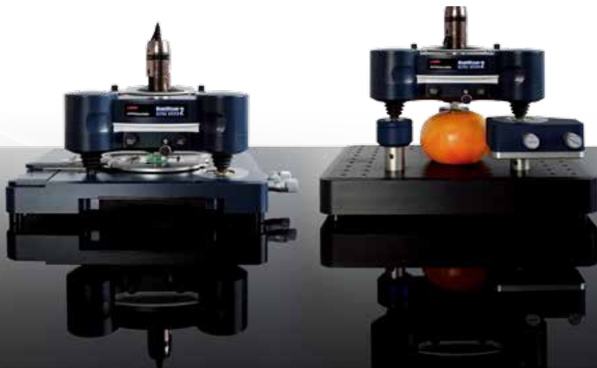
NanoWizard ULTRA Speed 2 ヘッドに搭載したTopViewOp- ticsモジュール
