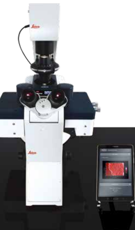
ライカの倒立顕微鏡(DMi8)に搭載されたHybridStage™, NanoWizard ULTRA Speed 2とExperimentControlをインストールしたタブレット
