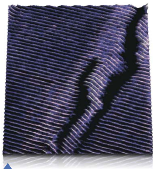
HOPG上に展開されたヘキサコンタン (C60H122) QI ™ モードによる、凝着カマッピング (Z-レンジ: 2nN) の3D表示 キサコンタンの単分子層が筋状に観察される スキャン範囲: 250 nm x 250 nm (XY-クローズドループ)
