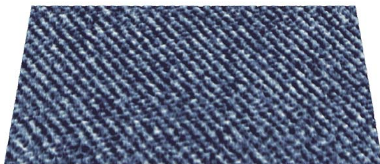
液中環境のカルサイトの原子像を倒立顕微鏡上で測定 スキャン範囲: 30 nm x 15 nm (XY-クローズドループ)
