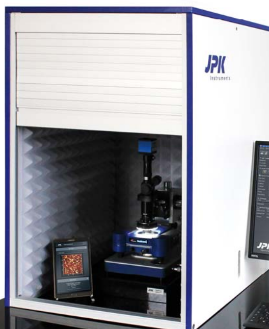
TopViewOptics ™ と NanoWizard ® 4 ナノサイエンスを JPK卓上型防音ボックスに設置
