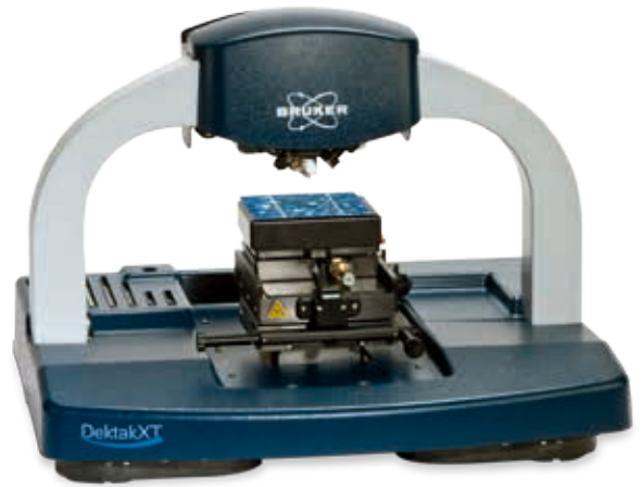
DektakXTのシングルアーチ構造とスマートエレクトロニクスにより高い測定再現性を実現
