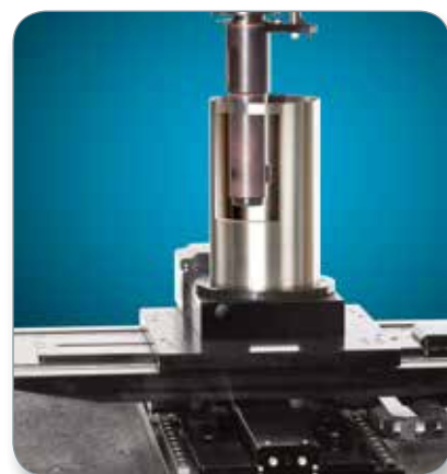
大型金属エンジンシリンダーライナーの内側 150mm のデータを取得するポアスコープ対物レンズ。
