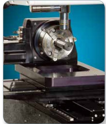
ファイ試料回転構成を用いた NPFLEX による測定。
