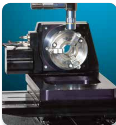
電動式 XY ステージに取り付けられたファイ駆動回転ステージ (部品を支える各種のチャックを搭載)。
