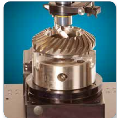
フォールドミラーオプションを用いたギア内表面の測定。
