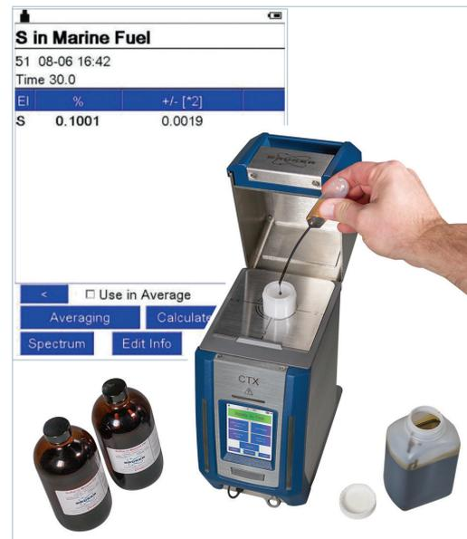
ポータブル蛍光X線分析装置CTXでは、硫黄、重金属、その他の元素の濃度閾値を入力することで、コンプライアンスの結果を迅速に確認できます。
