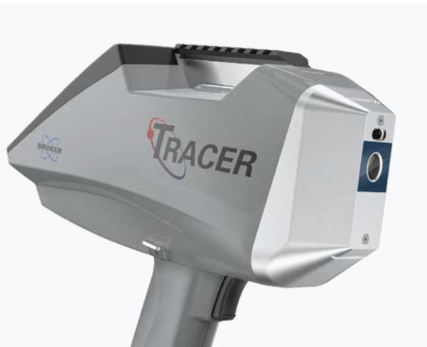
ブルカーのTRACER 5ハンドヘルド蛍光X線分析装置 (XRF) は、これまでにない機能を備えた研究者向けのソリューションです。先進技術をパワーや機能、精度、正確さと融合させることで、日常的なポイント&シュートテストから複雑な最先端材料研究に至るまで、あらゆる現場に対応できるダイナミックな元素分析を提供しています。フッ素やナトリウムのような軽い元素の測定もできます。また、電流や電圧の設定やコリメータの変更、カスタムフィルターの使用も可能です。TRACER 5は、地球上だけにとどまらない場所に存在する、ほとんどすべての物質の元素含有量の可視化、識別、分析を実現します。
