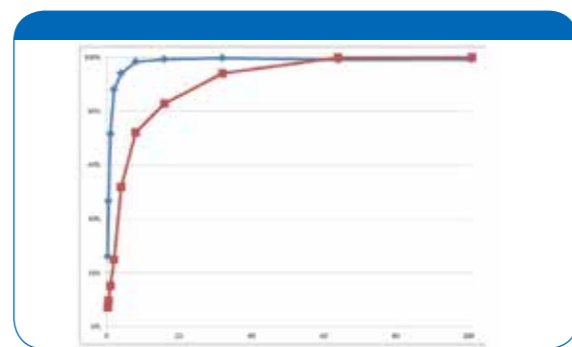
图 2: 高动态范围状态下,与 AVANCE III HD (红色)相比, AVANCE NEO (蓝色)的灵敏度提高。接收器增益低于 32 时,灵敏度提高20%至100%以上。
