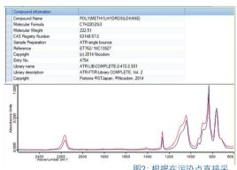
图2: 根据在污染点直接采集的FT-IR光谱, 在光谱参考库中检索结果。光谱采集自4000-600 cm<sup>-1</sup>范围。
