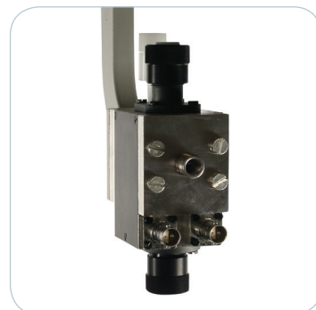
双模谐振腔，用于检测 S > 1/2 的禁止跃迁
