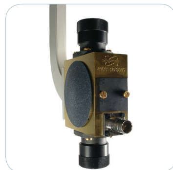
用于大体积含水样品的TM模式谐振腔
