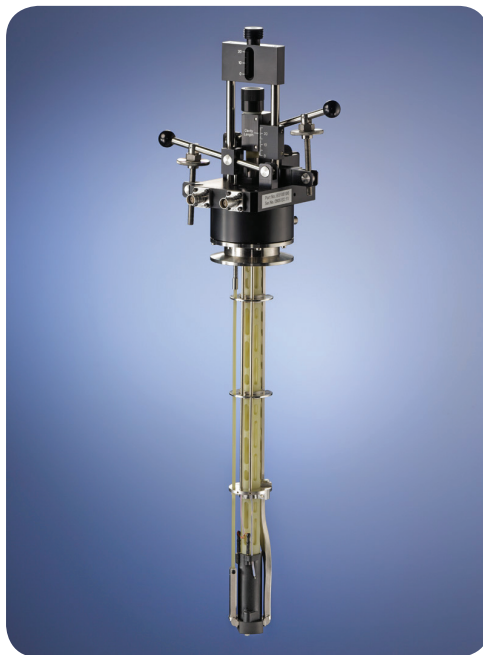
用于EPR、ENDOR和光激发的Q-波段谐振腔
