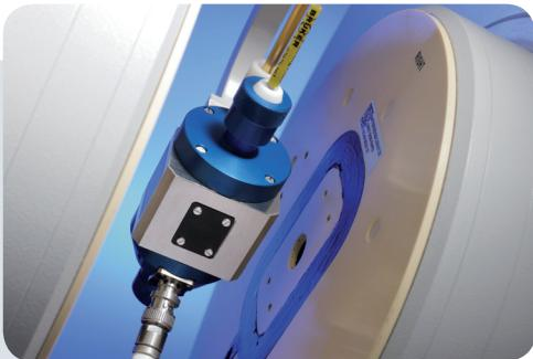
安装在磁极面上的快速扫描线圈
