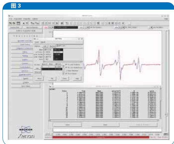
图 3 通过从 Xenon 的自由基加合物数据库导入或手动输入的方式，在 SpinFit 对话框中定义 DMPO 自由基加合物。SpinCount 模块会给出实验进行过程中拟合物种对应的面积的报告。
