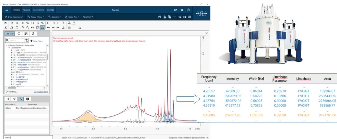
图1 显示了*mldcon*对400 MHz <sup>1</sup>H谱图的分析结果。图中右侧表格显示了*mldcon*确定的峰值参数示例。TopSpin *mldcon*可视化窗口中显示了*mldcon*分析结果，其中包括输入谱图（蓝色）、检测到的峰（灰色）、总和（重构谱图，红色），以及输入谱图和重构谱图之间的差值（残差，黑色）。该算法将分析结果存储为.csv文件，报告峰值化学位移、强度、线宽、线形类型、参数以及每个峰的面积。
