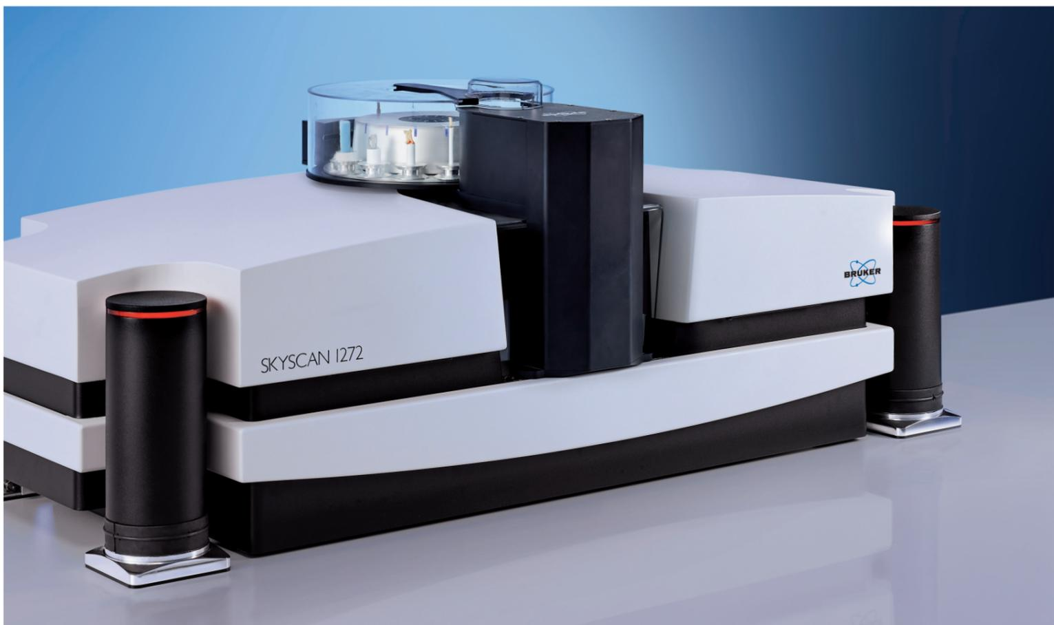
配置 16 位自动进样器的 SKYSCAN 1272
